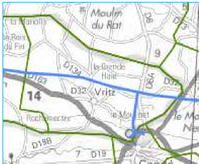
Tracé des conduites de gaz présentes sur le territoire de la commune déléguée de Saint-Mars-la-Jaille (Source : Ministère du Développement Durable)
