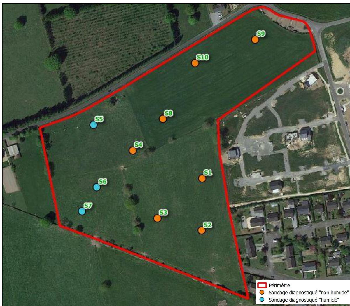
Figure 13 : Implantation des sondages (site 1)
