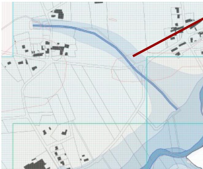
le zonage A\_i correspond à des secteurs soumis au risque inondation en fonction de divers paramètres enregistrés notamment les cotes de terrain, les hauteurs des crues les plus importantes..
