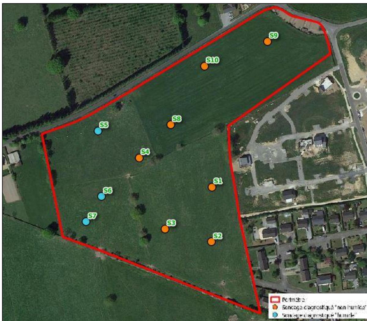
Figure 13 : Implantation des sondages (site 1)
