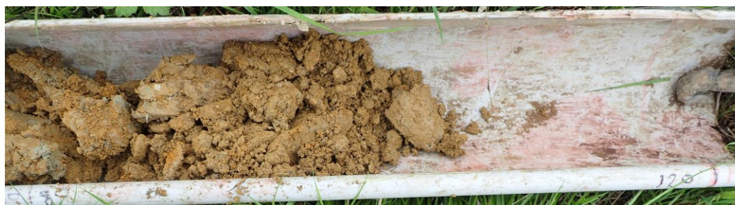
Échantillon prélevé entre 80 à 120 cm de profondeur – Pmax : 100 cm
