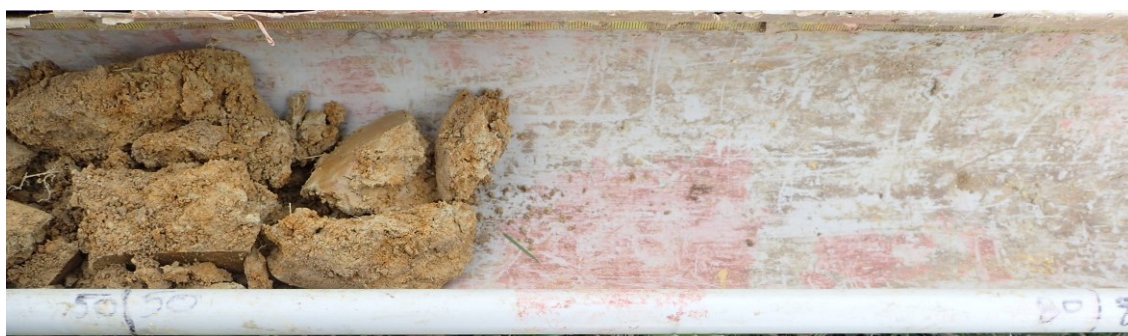
Échantillon prélevé entre 50 à 80 cm de profondeur – Pmax : 60 cm
