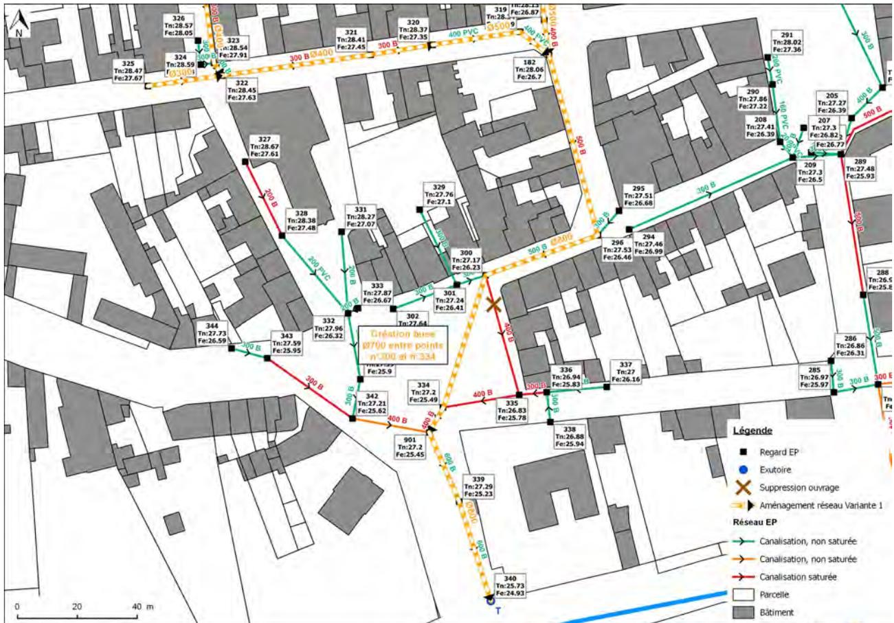
Il est important de souligner que les réseaux situés en aval du point n°181, sont situés en zone inondable (Lit majeur exceptionnel de l'Erdre). De ce fait, lors d'un événement pluviométrique exceptionnel entraînant une crue importante de l'Erdre, ces réseaux ne permettront plus d'évacuer les débits à gérer, la zone étant potentiellement saturée par l'Erdre. Cet aménagement n'est donc pas prioritaire.
