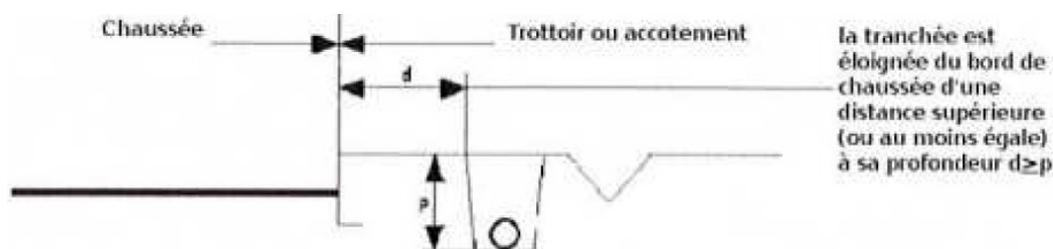
La tranchée doit être implantée à une distance du bord de la chaussée au moins égale à sa profondeur. Si cela est rendu impossible par la configuration des lieux, l'épaisseur du remblayage sera de 60,00 centimètres minimum, en grave 0/31.5, avec objectif de densification q3 sur au moins 60,00 centimètres.
